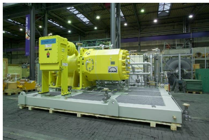
Рис. 1. Электроприводной газоперекачивающий агрегат 4 МВт
