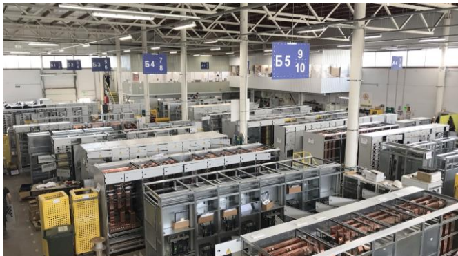
Сборка распределительных устройств низкого напряжения (PUNN) на базе НКУ
