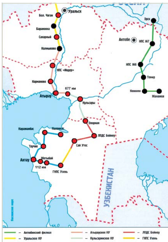
Рис. 2. Схема трубопроводов Западного и Актюбинского участков нефтепроводов
