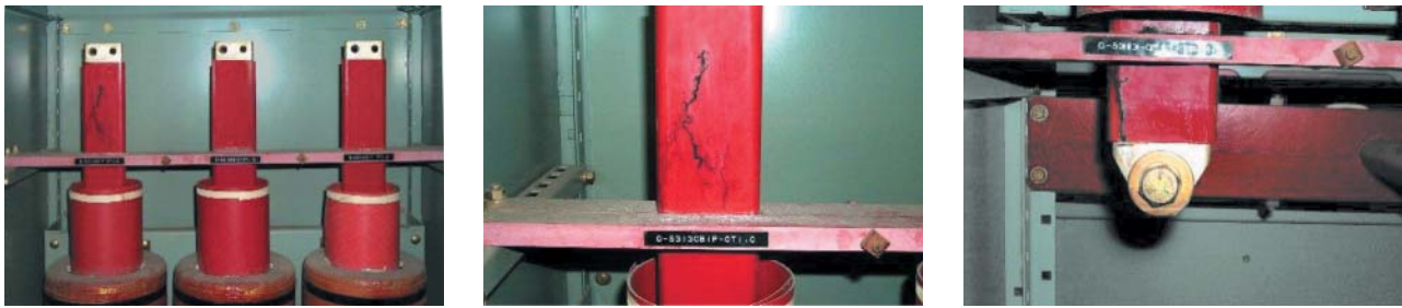
▲ Рис. 2. Примеры поверхностного трекинга ЧР в обмотках
