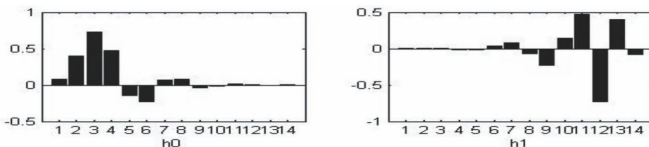
Рис. 1. Ортогональные фильтры Добеши, масштабирующая функция \psi и вейвлет \phi
