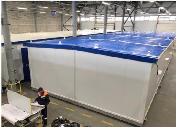
КТП-10/0,4 кВ представляют собой блочно-модульные здания полной заводской готовности.
