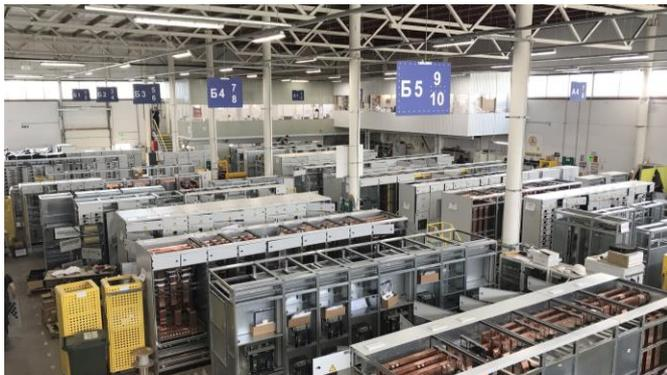
Сборка распределительных устройств низкого напряжения (ПУНН) на базе НКУ
