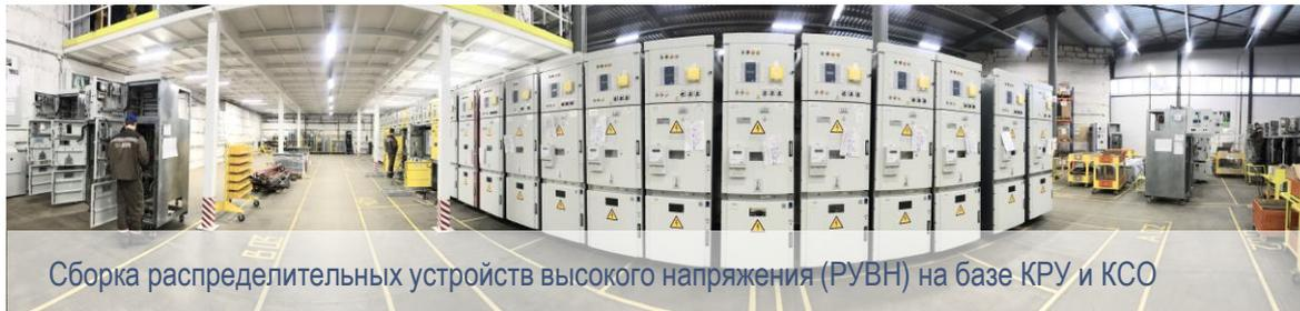
Сборка распределительных устройств высокого напряжения (ПУВН) на базе КРУ и КСО
