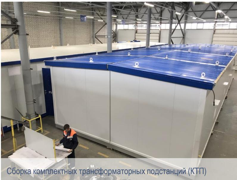
Сборка комплектных трансформаторных подстанций (КТП)
