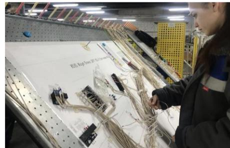
На участке применена инновационная технология - установка жгута по монтажным схемам согласно рабочей документации и технологическим картам: исключение ошибок; сокращение сроков выполнения заказов; снижение себестоимости
